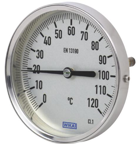
Bimetall-Thermometer Typ A52.100
