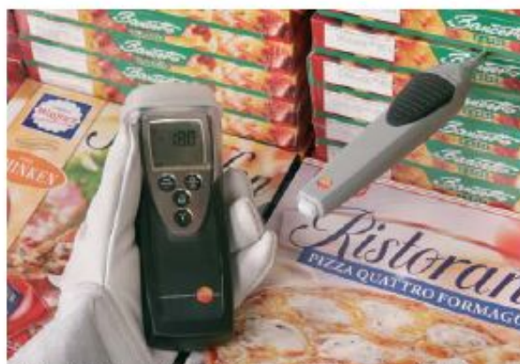
Hőmérséklet ellenőrzés áruátvételkor rádiófrekvenciás érzékelő alkalmazásával.
